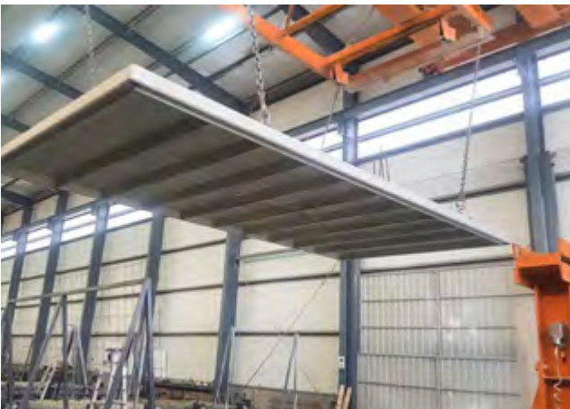
Exemple : Coffrage de toit pour upcrete®, pour un remplissage par le bas
