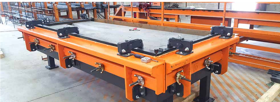
Coffrage pour toit plat avec contour au niveau de la face inférieure, pour remplissage par le haut
