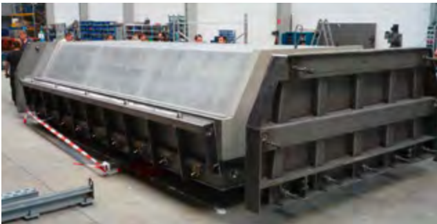
Coffrage de toit
