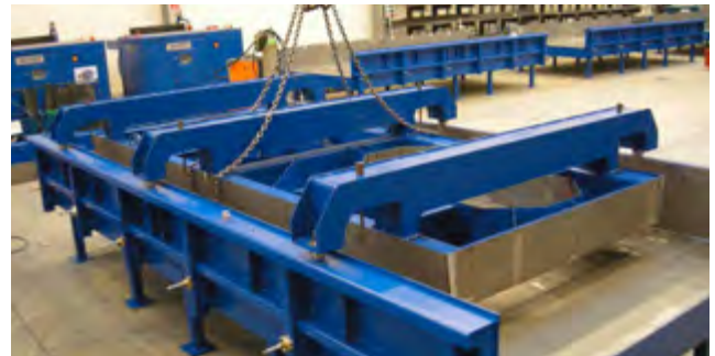
Coffrage spécial pour caissons d'about
