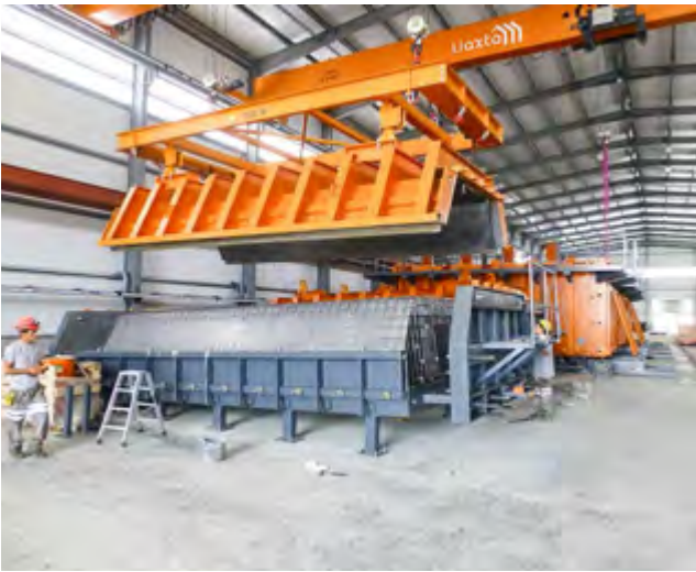
Exemple : Coffrage de toit pour upcrete®, pour un remplissage par le bas
