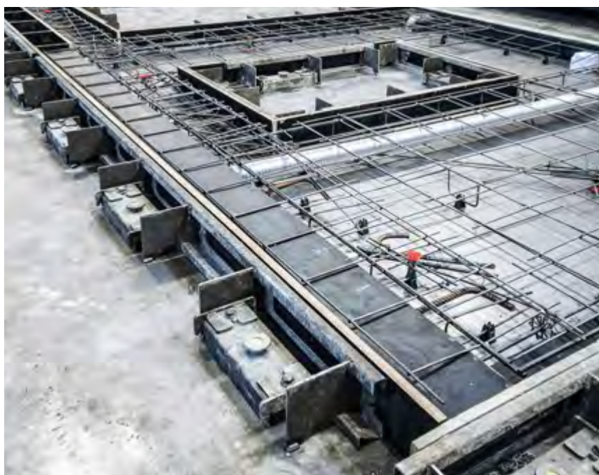
MST en tant que système complet pour coffrage extérieur et évidement
