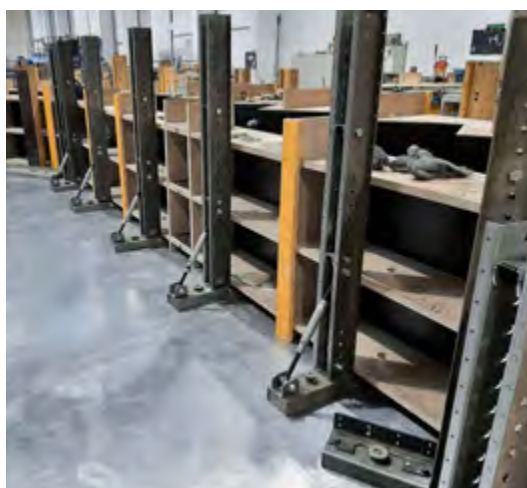
Easy Form avec des supports verticaux peut être utilisé pour la fabrication d'éléments en forme de barre ou d'escaliers par exemple
