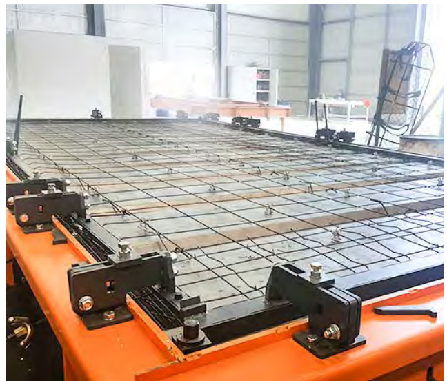
Coffrage pour toit plat avec contour au niveau de la face inférieure, pour remplissage par le haut
