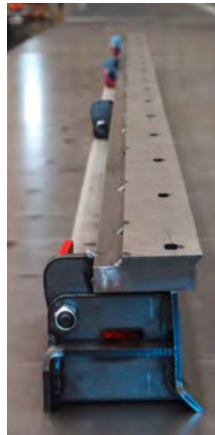
Sonderlösung für TT Pro mit klappbarem Oberteil
