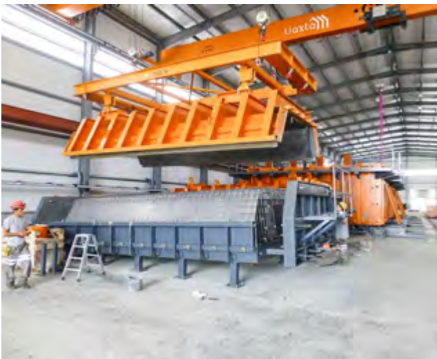
Beispiel: Dachschalung für upcrete®, für die Befüllung von unten
