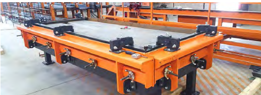
Schalung für ein Flachdach mit Konturierung an der Unterseite, für die Befüllung von oben
