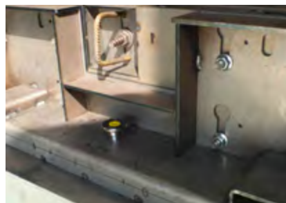
SAS-MF mit Anbaumodul für durchgehende Bewehrung
