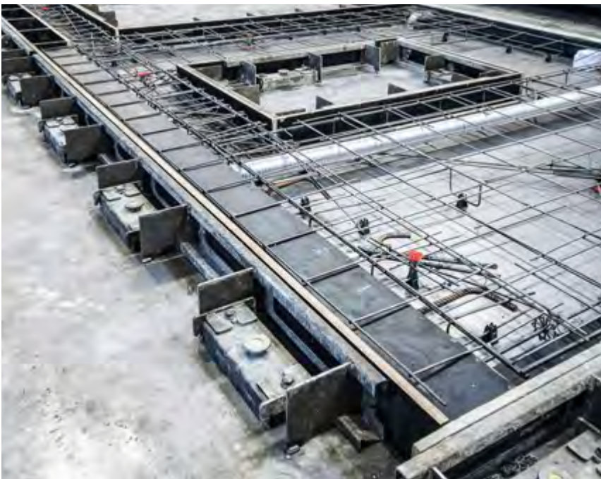
MST als Komplettsystem für Außenschalung und Aussparung
