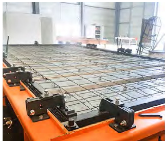
Schalung für ein Flachdach mit Konturierung an der Unterseite, für die Befüllung von oben
