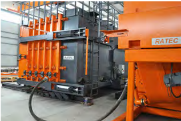
Hydraulische Batterieschalung mit Pumpwagen
