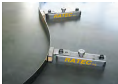
SPB mit Stirnwinkelaufsatz für Radienschalung
